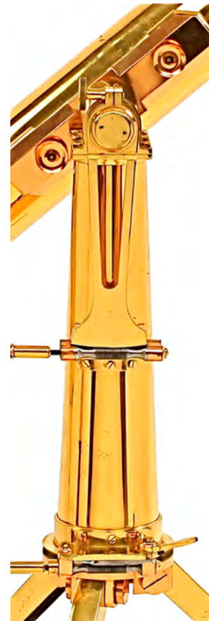
Upper: altitude adj. Lower: azimuth adj.
